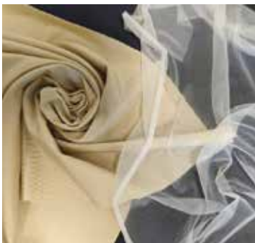
尼龙氨纶混纺织物（左）及分离的氨纶（右）。
