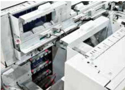
自动络筒机配备了两个滑槽装置, 最大可实现每分钟供给 54 个筒子。
