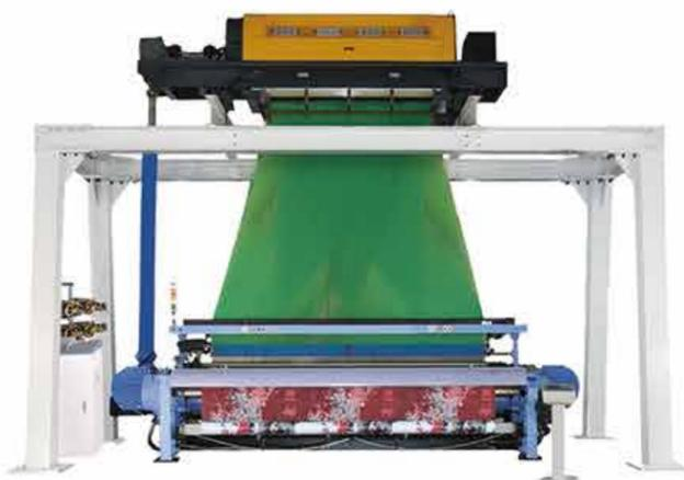
独特螺杆传剑及无轨自由飞行引纬配合中央凸轮打纬方式，令织机运行速度可达650转/分钟，打纬力更强，运行更稳，噪声更低。
