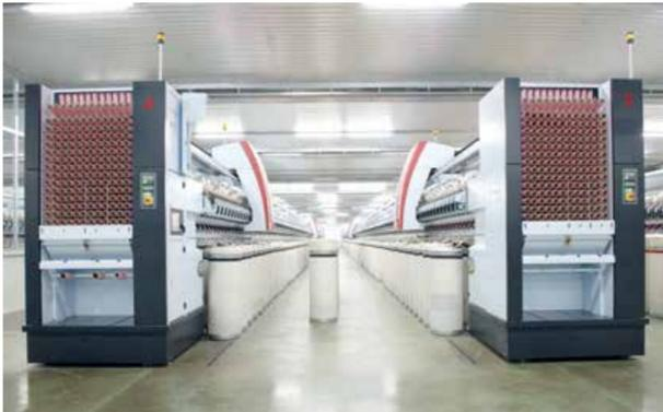
卓郎全自动络筒机 Autoconer 使用陶瓷涂层进行再生 PET 纱线的络纱加工。
